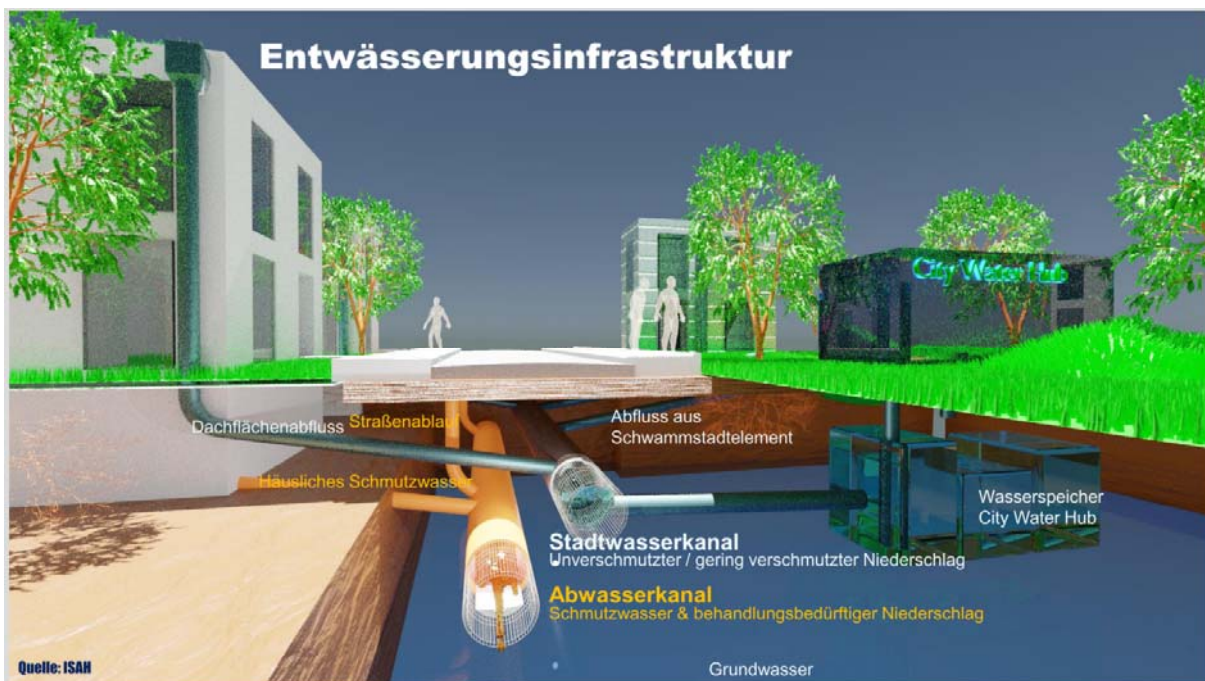
Abbildung 179: Entwässerungsinfrastruktur einer Schwammstadt, Vorschlag (Köster & Beier, 2023)
