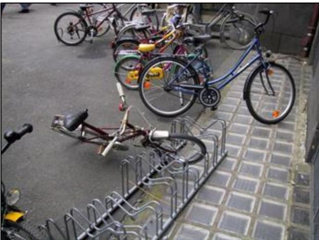
Abbildung 4 Fehlende Standsicherheit bei Vorderradhaltern
