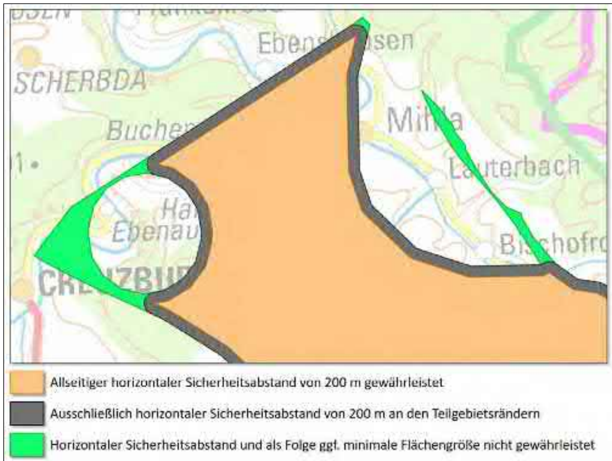
Abb. 60: Entfernen von Verschnittresten, in denen der horizontale Sicherheitsabstand von 200 m unterschritten wird, im Teilgebiet Mitteldeutsche Kristallinzone (Ausschnitt im Raum Mihla-Lauterbach-Bischofroda).
