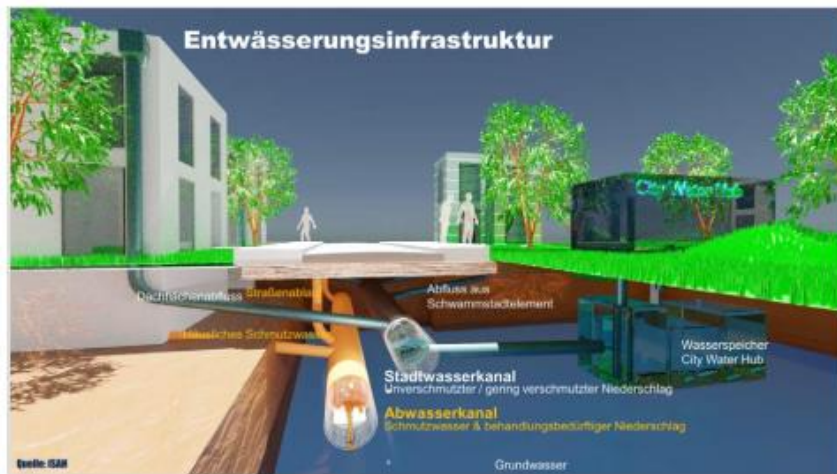
Abbildung 179: Entwässerungsinfrastruktur einer Schwammstadt, Vorschlag (Köster & Beier, 2023)
