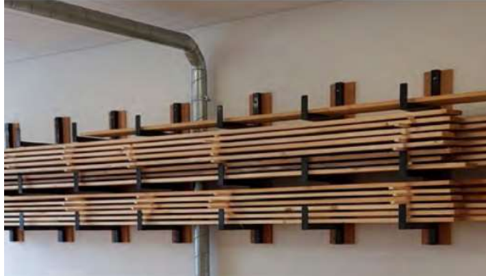
Kragarmregal für die Lagerung von Profilen, Stangen und Rohren
