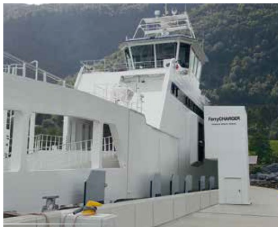
Abbildung 4: automatisiertes Laden einer Fähre mit dem System FerryCHARGER des Herstellers Stemmann (Quelle: Produktbroschüre FerryCHARGER Stemmann-Technik)
