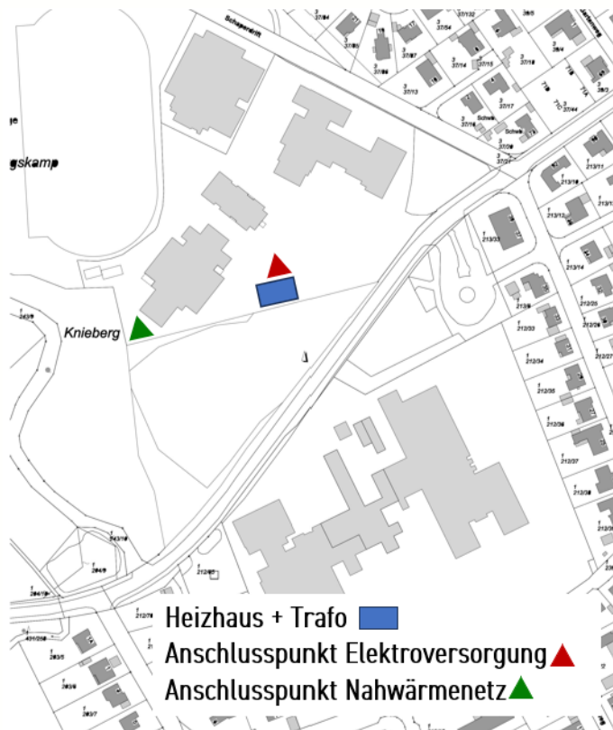
Abbildung 27 – Konzeptlage Heizhaus / Trafo mit Anschlusspunkten Nahwärme + ELT
