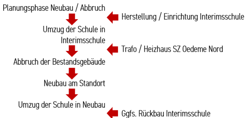
Abbildung 25 – Konzept Projektablauf Neubau Standort
